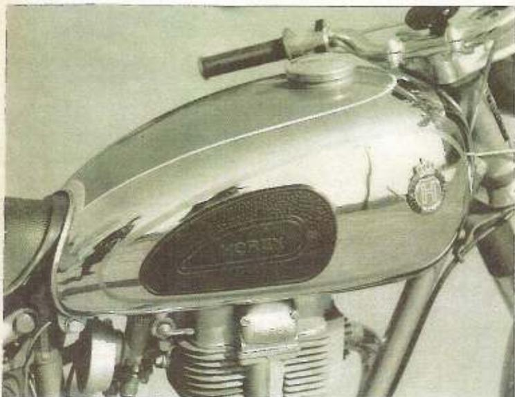
Der formschöne 13-Liter-Tank wurde von der «Regina de Luxe» 350 cm<sup>3</sup> übernommen. Der grosse Inhalt ermöglicht bei einer Dauergeschwindigkeit von 70 km/h einen Aktionsradius von 600 km. Die nach oben schräg angeordneten, grossen Knieschalen erlauben einen anatomisch korrekten Knieschluss
